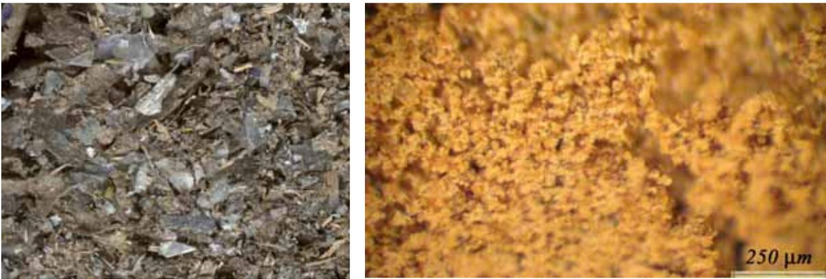
Figura 4: Tal quale macinato a 30 mm e dopo il trattamento meccanochimico di micronizzazione (microscopio ottico)
